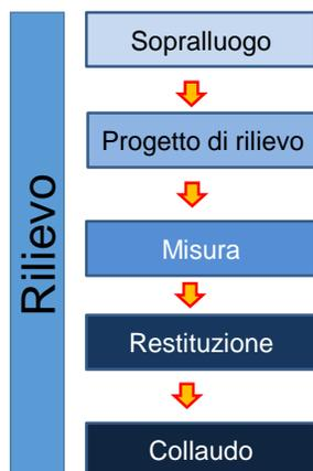
In un progetto di rilievo indiretto - con strumentazione topografica, fotografica o laser scanner - non consideriamo solo le operazioni di misura di un oggetto / monumento ma tutto il processo che va dalla pianificazione, misura vera e propria in "campagna" fino alla rappresentazione finale, considerando quindi tutta la complessa fase di elaborazione dei dati acquisiti.
